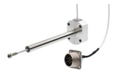
Induktiver Wegaufnehmer in Halbbrückenschaltung, in Ø12 mm Gehäuse mit Sonderflansch, kalibriert auf 80 mV/V Nennsignal, erhöhte Impedanz, besonders geeignet zum Einbau in
