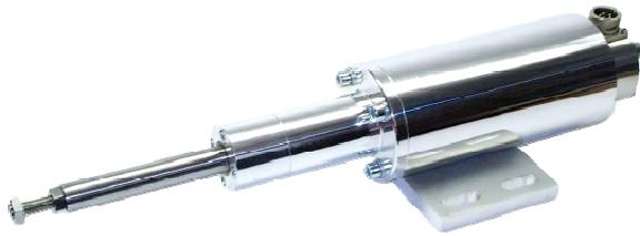
Induktiver Wegmesstaster, speziell zur Messung von Lagerwellenausdehnung, mit integrierter 4...20mA 2-Leiter Elektronik, auch zum Betrieb in 3-Leiter Anschaltung verwendbar.
